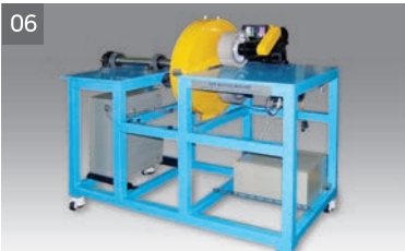
04 3단 확관기 3stage Expansion MC 05 히시튜브 가열기 Shrinkable tube heating MC 06 버핑기 Buffing MC 07 버핑 된 제품 Buffered Parts
